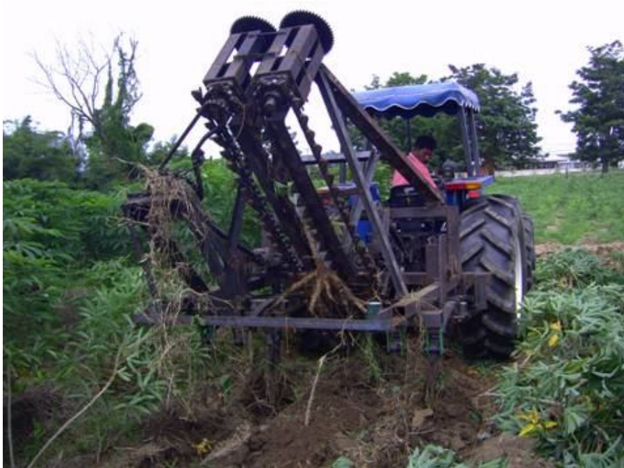
รูปที่ 2 โซลาล์เสียงของเครื่องเก็บเกี่ยวมันสำปะหลังขณะกำลังดึงก้อนมันสำปะหลังขึ้นมาจากพื้นดิน
